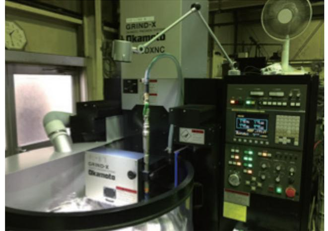
ものづくり補助金で導入した平面研削盤
