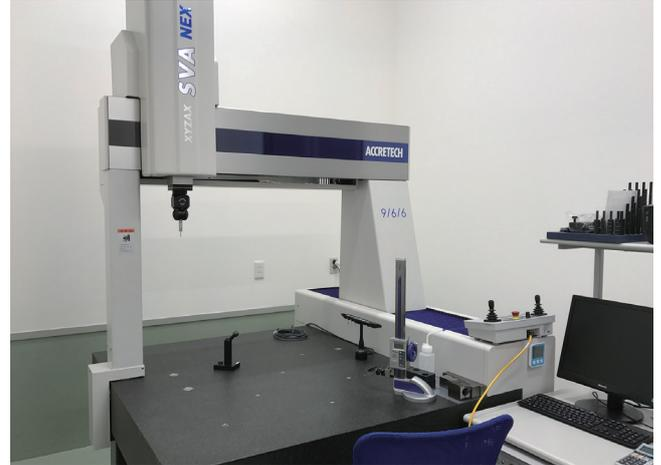
ものづくり補助金で導入した「三次元座標測定器」
