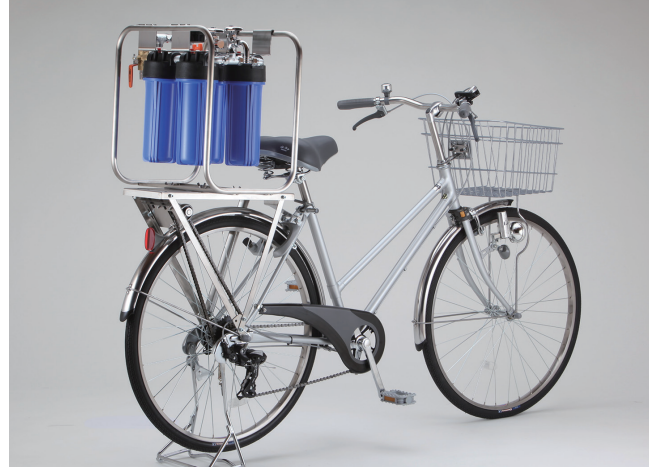
被災地などでの緊急用浄水器として開発した浄水自転車
