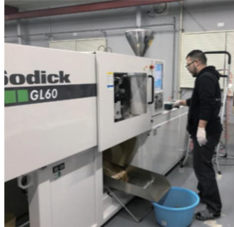
成形工程で使用する射出成形機
