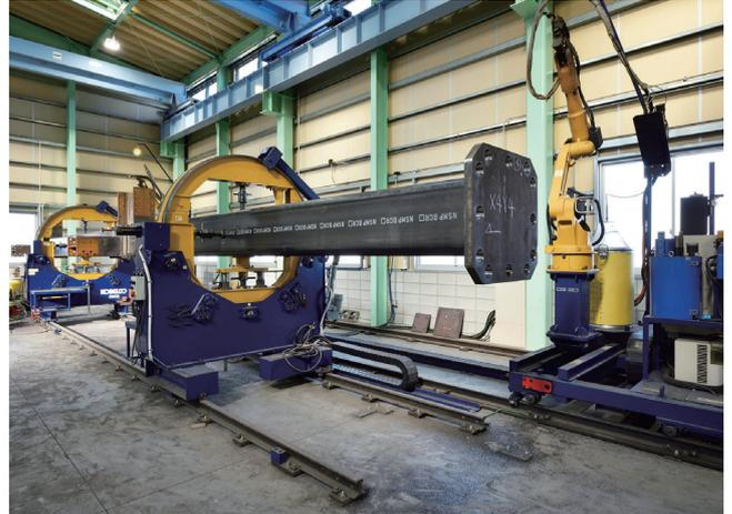
平成29年度補正ものづくり補助金で導入した柱大組立ソーアーク溶接ロボット
