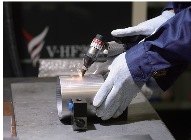
導入したファイバーレーザー溶接機
